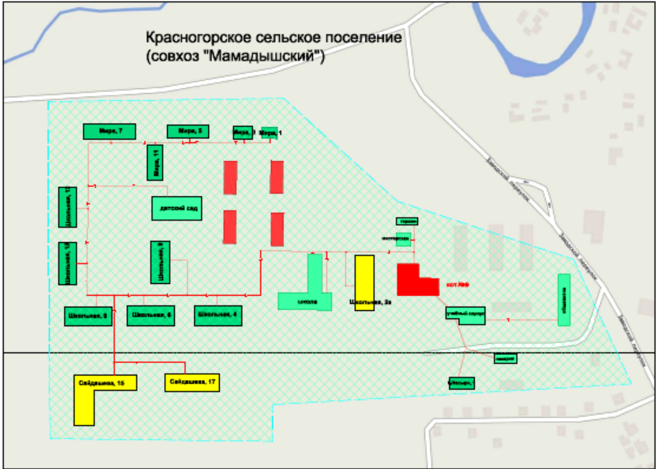
рис. 9 - Зона действия Котельной №9
