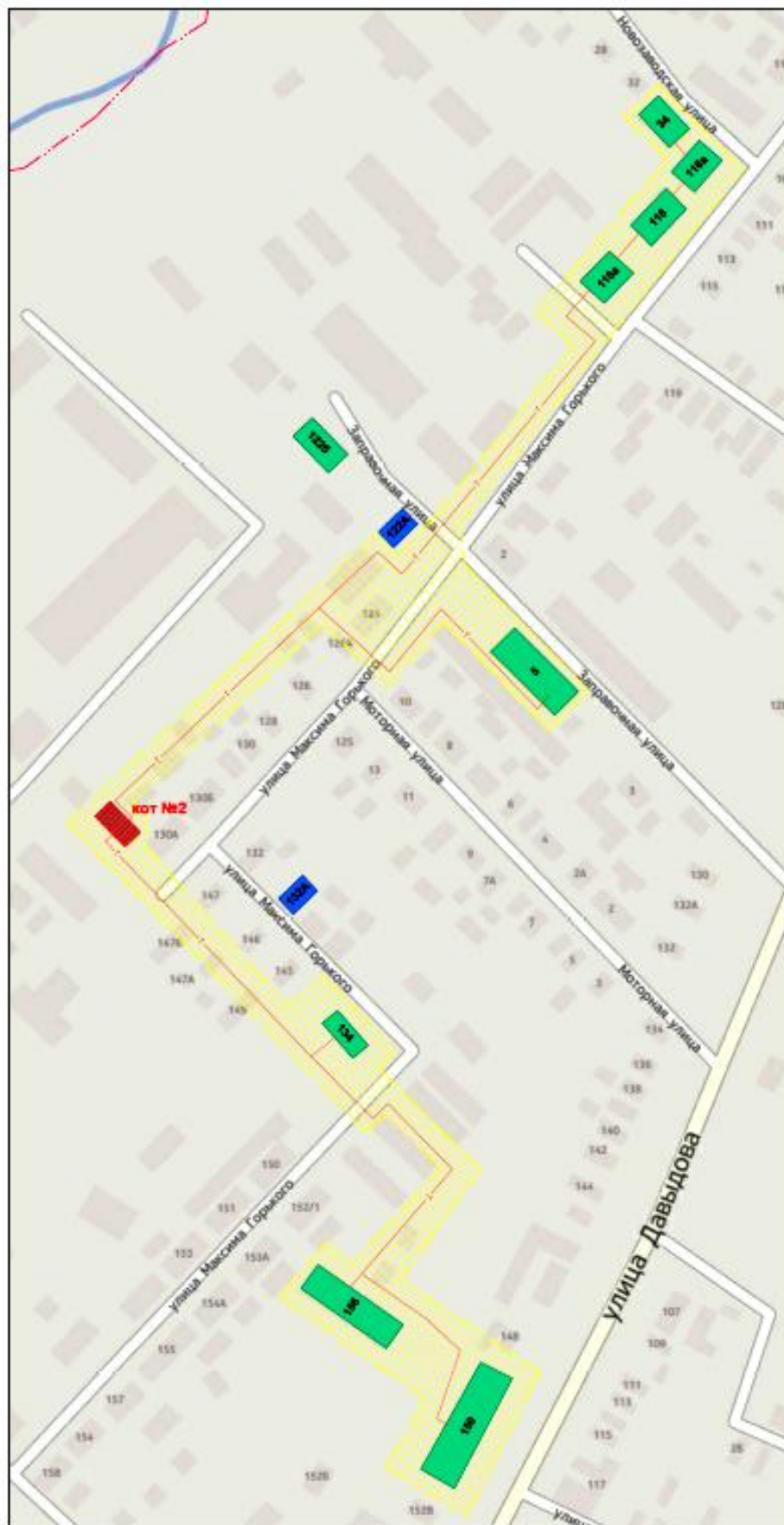
рис. 3- Зона действия Котельной №2
